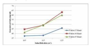
Gambar 9. Pengaruh suhu hidrolisis terhadap perolehan glukosa pada variasi waktu hidrolisis dan volume HCl 0,5 N tetap 10 ml
